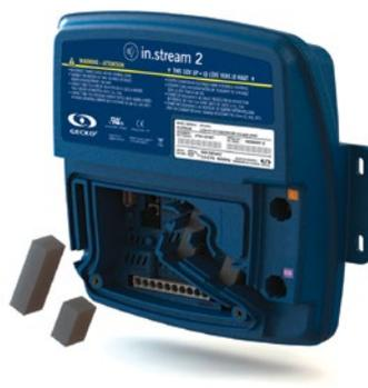
Retire la cubierta y deje de lado los sellos de espuma que están colocados en los conductos del cable.
