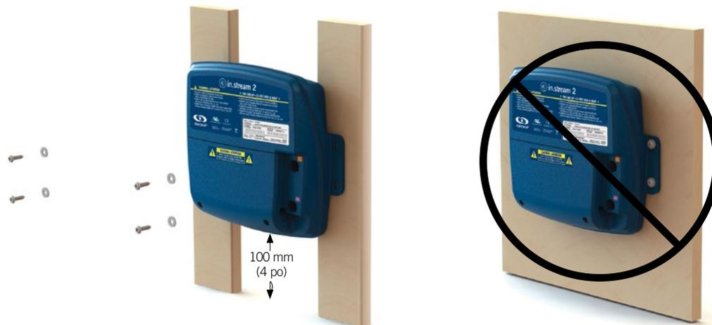
*Nota: el in.stream 2 debe ser instalado a al menos 100 mm (4") por encima del nivel de inundación potencial. Un espacio de al menos 19mm (0.75") es requerido para que el calor circule libremente en la parte trasera de la unidad.*
