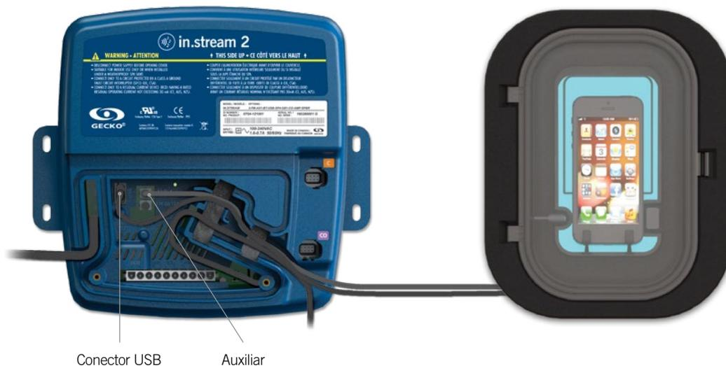
Para conectar la estación in.p4 al in.stream 2, simplemente inserte el cable USB y el cable stereo 3.5 mm (1.8”) en sus respectivas entradas USB y auxiliar como se muestra en la figura.
