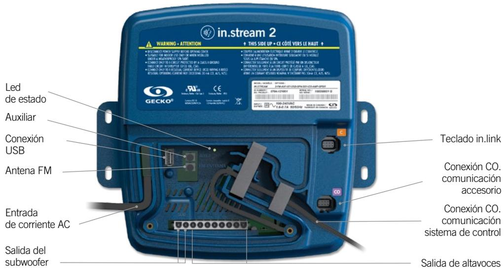
Dependiendo de la configuración seleccionada, el in.stream 2 puede soportar hasta 4 altavoces, 1 subwoofer, una entrada auxiliar, un receptor radio FM, un receptor Bluetooth y una conexión USB con capacidad de carga de hasta 1A.
